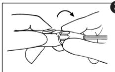
2. Drehen Sie die Rändelmutter mit der Hand fest. Drücken Sie den Einsatz zum Einstellen desselben nach innen und drehen Sie ihn dabei im Uhrzeigersinn.
