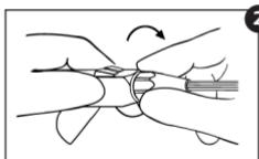
2. Вручную затяните гайку с накаткой. Чтобы изменить направление наконечника, следует надавить на него и повернуть по часовой стрелке.
