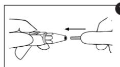
1. Quando il dado ad alette è allentato, inserire un nuovo puntale monouso Sani-Tip® e spingere nell'adattatore il più a fondo possibile. Mentre si spinge all'interno, ruotare il puntale di 1/2 giro in senso orario per creare una tenuta stagna sull'asse interno affusolato per l'acqua.
