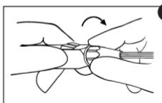
2. Serrer l'écrou d'extrémité à la main. Pour repositionner l'embout, l'enfoncer en tournant dans le sens des aiguilles d'une montre.
