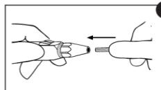
1. Una vez aflojada la tuerca, inserte la nueva punta desecharable Sani-Tip® e introduzcalo en el adaptador todo lo que pueda. Mientras empuja hacia adentro, dé media vuelta a la punta en el sentido de las agujas del reloj de forma que quede herméticamente unida al husillo interno para el agua.
