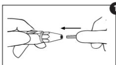
1. При ослабленной гайке с накаткой установите новый одноразовый наконечник Sani-Tip® и введите его в переходник как можно глубже. Продолжая вводить наконечник внутрь, поверните его на пол оборота по часовой стрелке, чтобы создать герметичное уплотнение вокруг внутреннего конического шпинделя водяного охлаждения.
